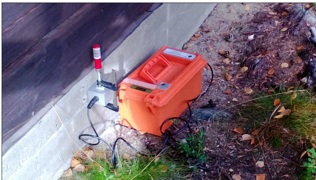
Kuva 3-6 Tärinämittari ja perustukseen kiinnitetty anturi.
