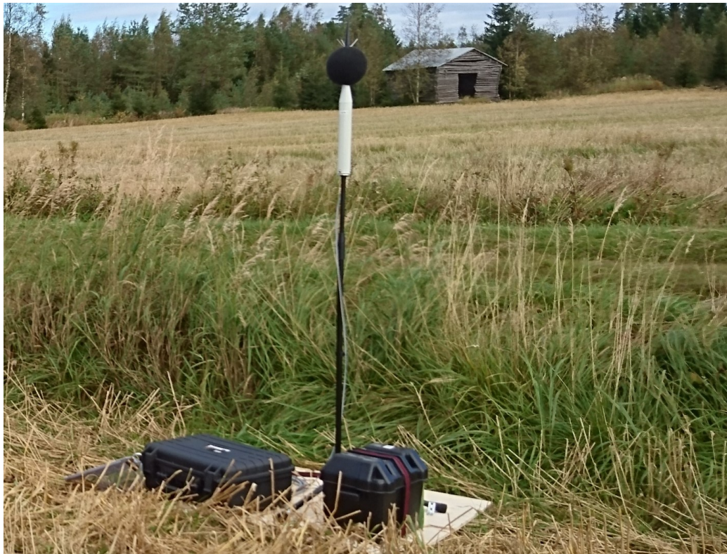
Kuva 2-1 Melumittari sääsuojavarustuksella (Kuva: FCG)
